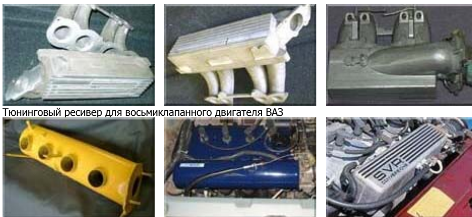
Тюнинг-ресиверы на 16V - самодельный и SVR Conversions
