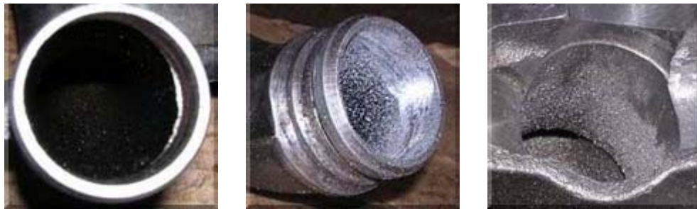
А это впускные каналы 16-кл. впуска. Слева - заводская отливка, в центре - обработанная. Справа - доработанная 16-кл. ГБЦ под вал с большим подъемом.
