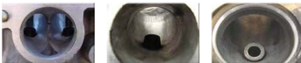
16V Так выглядят шлифованные каналы ГБЦ 8V
